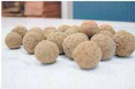
Composto ecológico - Brita por pesquisadores de Ufscar para substituir a brita. Usam resíduos de lodo de esgoto e serragem.
