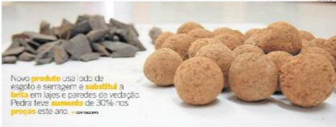
Novo produto usa lodo de esgoto e serragem e substitui a brita em lajes e paredes de vedação. Pedra teve aumento de 30% nos preços este ano.
